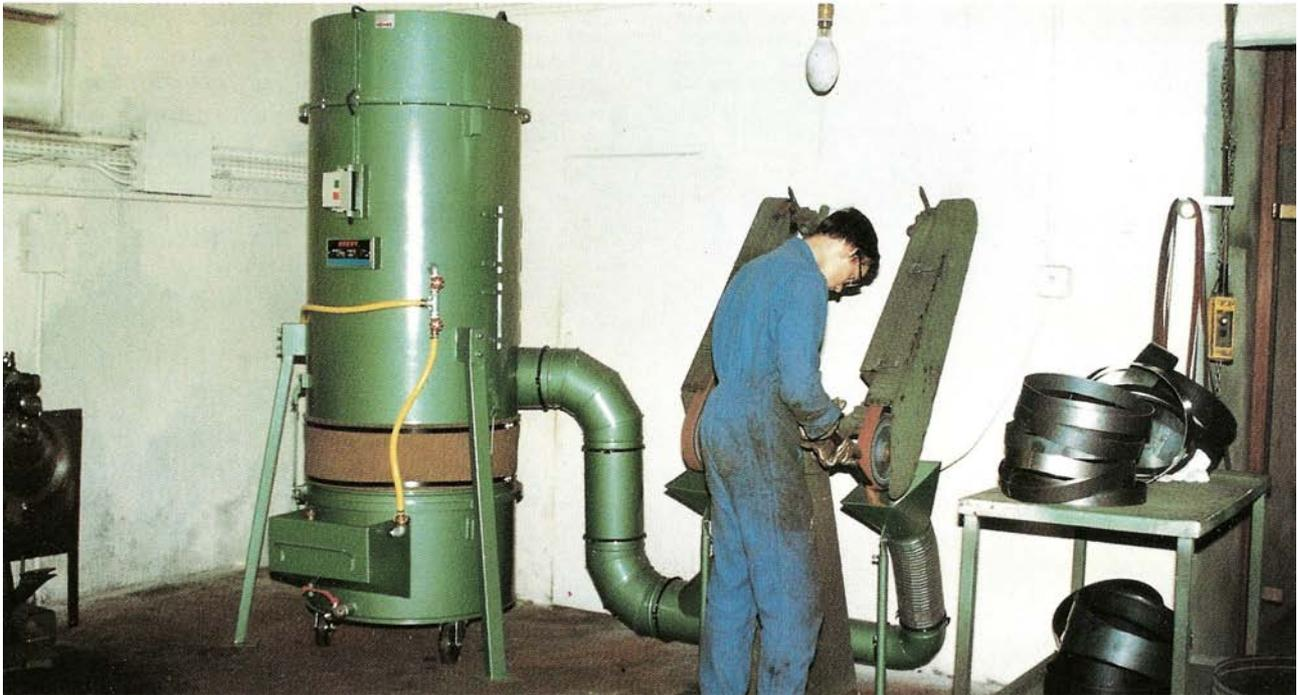
Les dépoussiéreurs MBH sont des appareils monobloc à voie humide spécialement conçus pour équiper soit des postes individuels soit des installations où le débit d'air à traiter est relativement moyen (8 à 10.000 m<sup>3</sup>/h).
